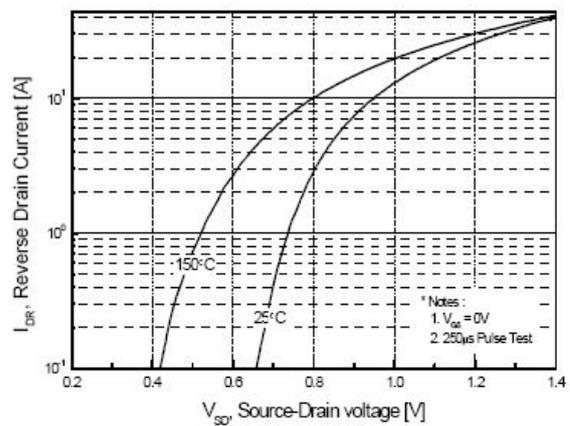
图 4 二极管正向电压曲线
