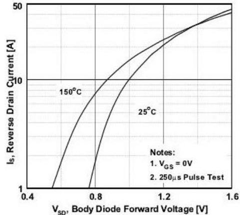
图 4 二极管正向电压曲线
