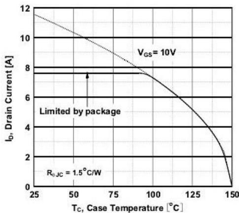
图 5 最大漏极电流与壳温曲线
