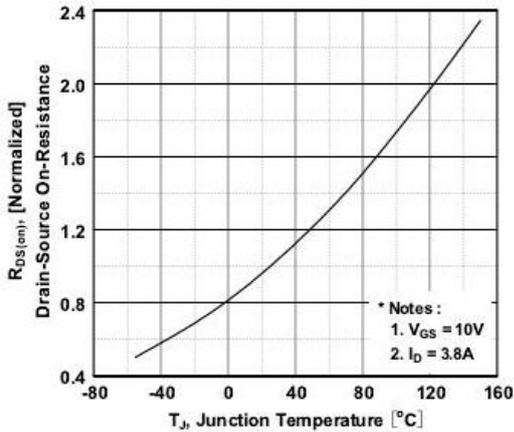
图 3 导通电阻与温度曲线
